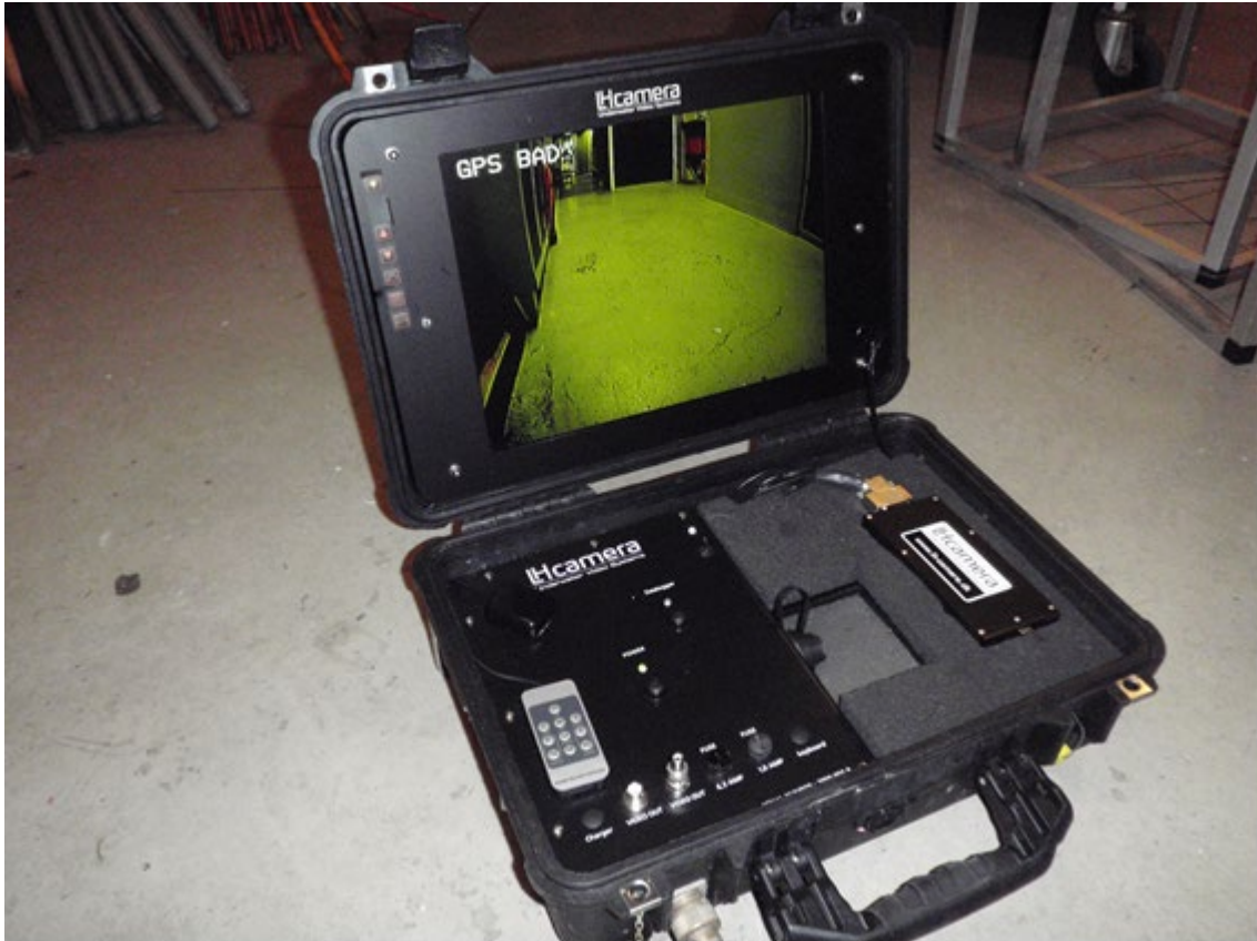
Figur 2 Videosystemets overfladedel indeholder: Kontrolpanel til undervandskamera, GPS, video-overlay til GPS og brugertekst, digital videooptager og datalogger, samt markørterminal.
