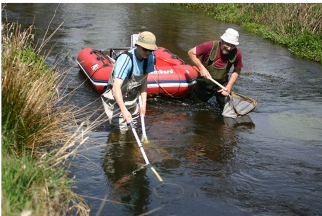
Figur 3. Generator, ensretterboks og baljer er placeret i gummibåd, som trækkes af medhjælperen. Dette minimerer tidsforbruget ved håndtering af de fangne fisk, ligesom man undgår problemer med at kablet sætter sig fast. (Jens Skriver foto).
