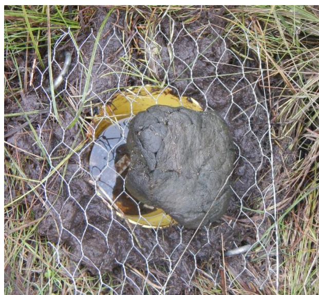
Figur 2 viser et eksempel på opstillingen af faldfælderne (her ses krondyr-møg). Faldfælderne er 10cm i diameter og 8cm i dybden, med en 4 % Udendørs Rodalon opløsning (benzalkoniumchlorid og demineraliseret vand) som killing-agent. Faldfælden graves ned i jorden, således at den øvre kant er i plan eller lidt under jordoverfladen. Ovenpå faldfælden lægges et metalnet (huller 1,5cm i diameter), og maddingen blev lagt på dette, således at der er hul ned i faldfælden hele vejen rundt. Pløkkerne bruges til, at sikre fælden mod hærværk (eksempelvis fra heste).
