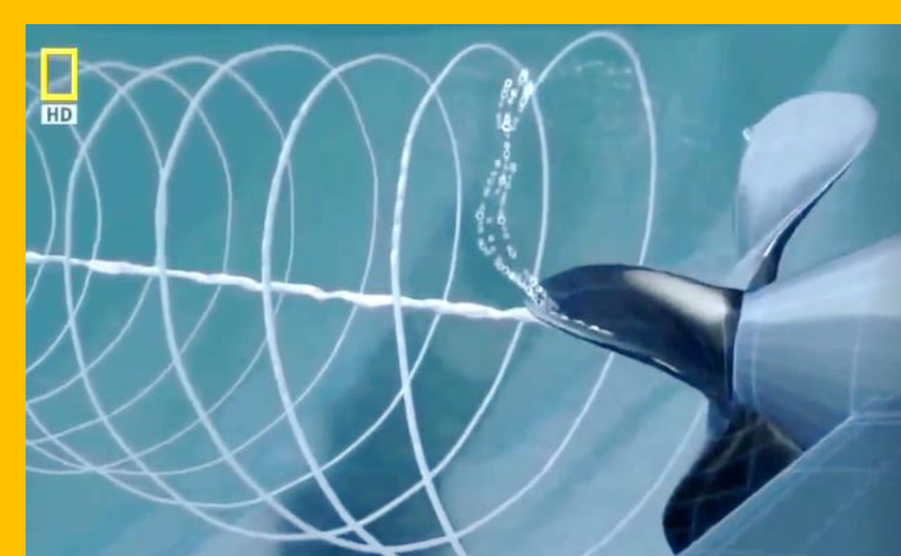
Fig. 1. Kavitationsbobler laver støj når de sprænges. Støjens frekvens afhænger af boblernes størrelse.
