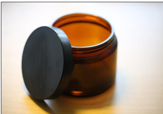
Figur 1. 500 ml prøveglas egnet til opbevaring af mesozooplankton fikseret i neutral Lugol-opløsning.
