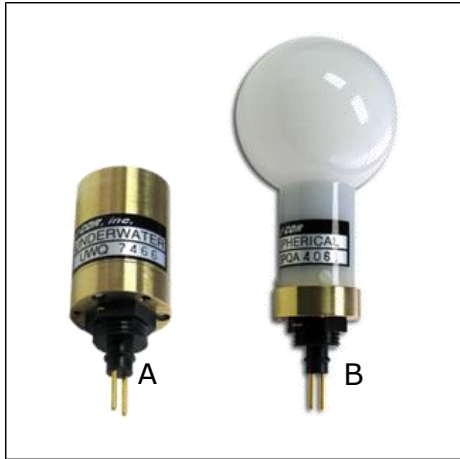
Fig 3. To typer af cosinus-korrigerede kvantum lyssensorer. A: 2\pi -sensor måler lys fra alle retninger over sensoren. B: 4\pi -sensor måler fra alle retninger omkring sensoren.
