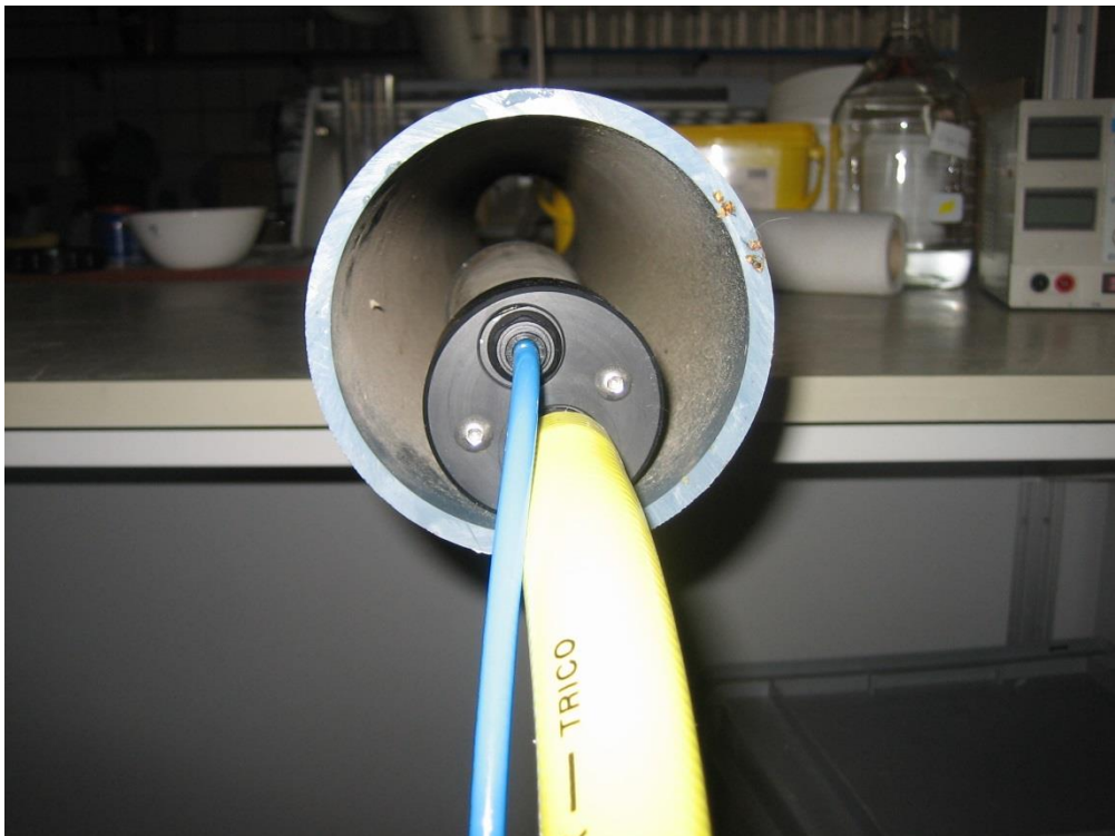
Figur 5.3 Manchetten er ført ind i et drænrør og kan herefter pustes op som vist på figur 5.4. Den gule slange føres op til vandoverfladen og vandføringen i drænet kan herefter måles.
