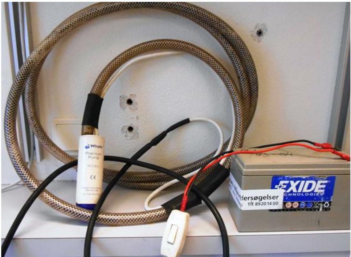
Figur 6.2 Billedet viser en elektrisk pumpe koblet til et lille 12 V batteri. Pumpen kan sænkes ned i et piezometerør med \varnothing > 40 mm og bruges til tømnning og vandprøvetagning.
