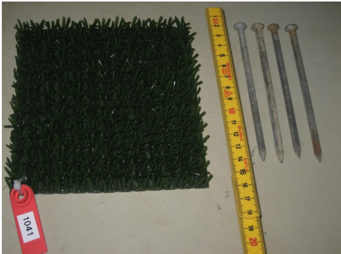
Figur 10.1: Foto af måtte i laboratoriet med påsat ID-mærke med nummer og de 13 cm lange søm som anvendes til forankringen af måtten på engen.
