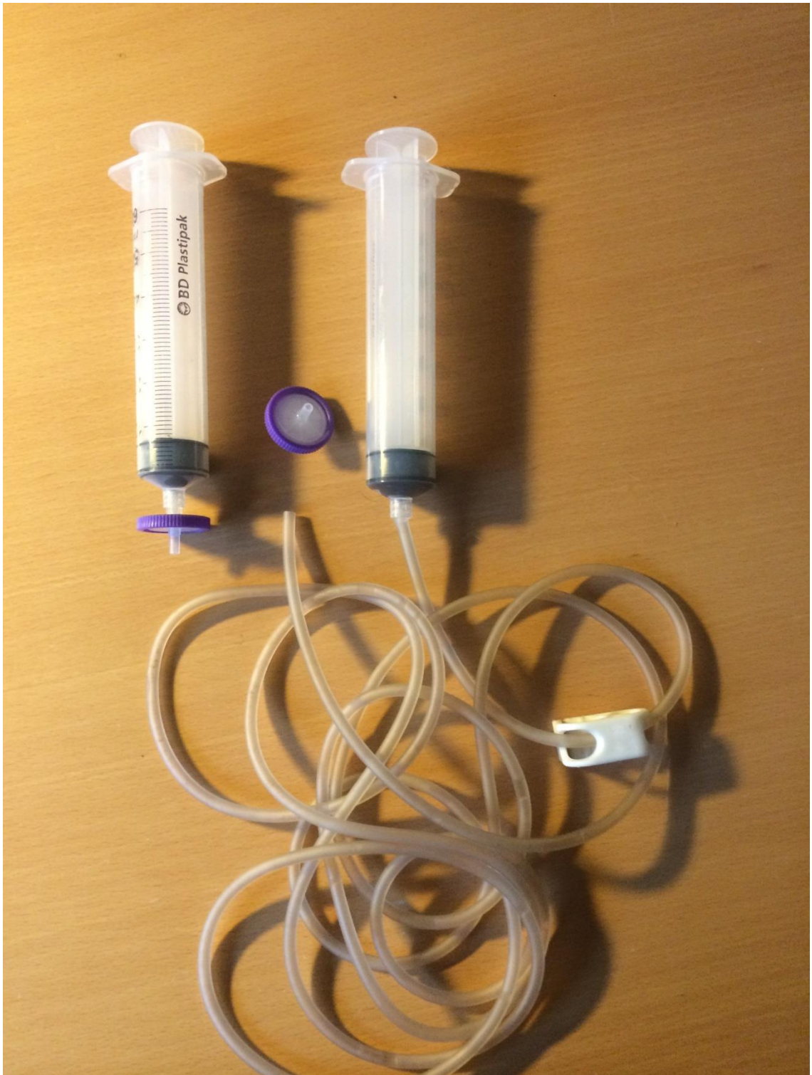
Figur 7.1 Stor plastic sprøjte påmonteret plasticslange kan være god til prøvetagning, hvor der kræves ekstra påpasselighed f.eks. i dræn eller bittesmå vandløb. Når vandprøven er taget, kan man påmontere et engangsfilter og straks filtrere prøven.
