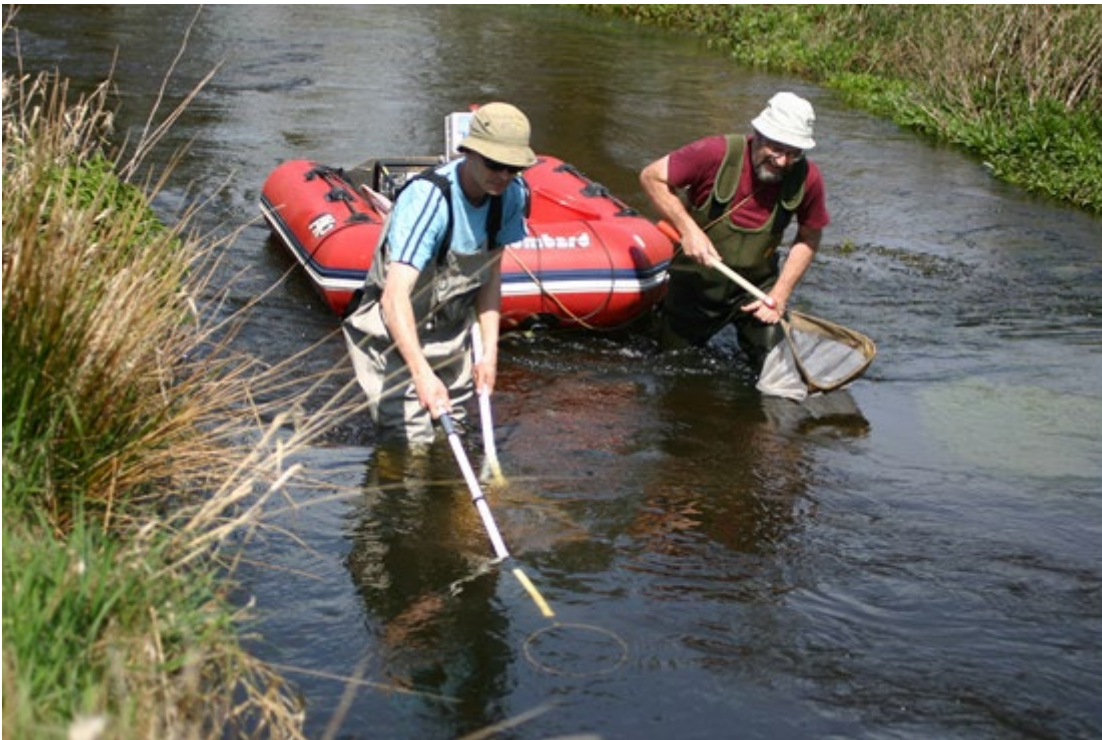
Figur 3. Generator, ensretterboks og baljer er placeret i gummibåd, som trækkes af medhjælperen. Dette minimerer tidsforbruget ved håndtering af de fangne fisk, ligesom man undgår problemer med at kablet sætter sig fast. (Jens Skrivers foto).
