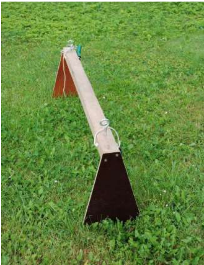
Figur 2. Bom til fastgørelse af tov/wire ved brug af gummibåd i ikke-vadbare vandløb. Bommen placeres på tværs af gummibåden – umiddelbart bag sædet. Bommen skal være så bred, at den lige akkurat kan "klemmes" ned over ydersiden af båden. Bommen fastgøres ved hjælp af nylonsnor til båden, på siderne placerede bærehåndtag. Tov/wire føres igennem de to metalkluge. Det gør fastgørelse og frigørelse af tov let.
