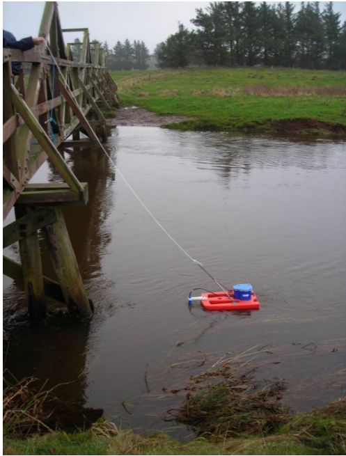
Figur 3. Figuren til venstre viser et eksempel på en bromåling udført med tov. Billedet til højre viser et eksempel på en bromåling udført med stang
