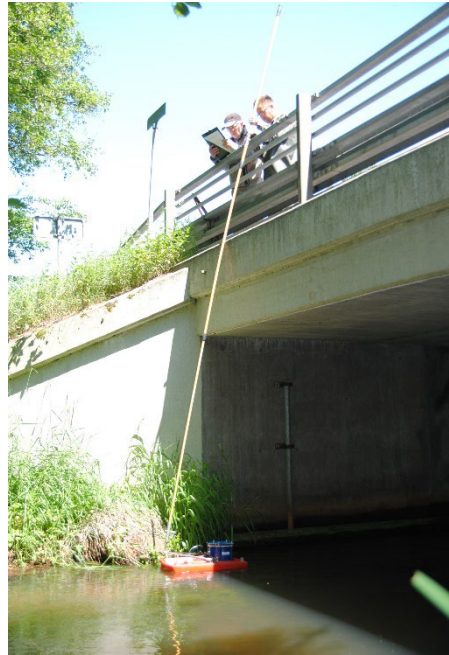
Figur 3. Figuren til venstre viser et eksempel på en bromåling udført med tov. Billedet til højre viser et eksempel på en bromåling udført med stang
