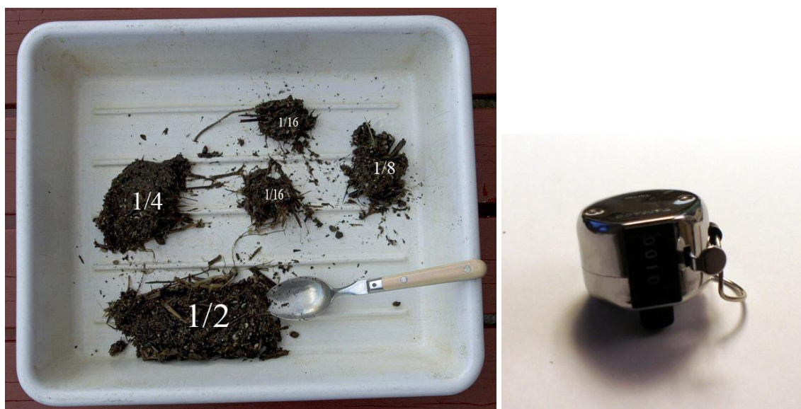
Figur 3. Subsampling (opdeling) af den skyllede og drænedede prøve. Det kan enten gøres i sigten eller som her i en bakke. Herefter kan de mindre dele af den samlede prøve sorteres. Desuden vist tælleur til optælling af individer (foto: Jan Grandahl).
