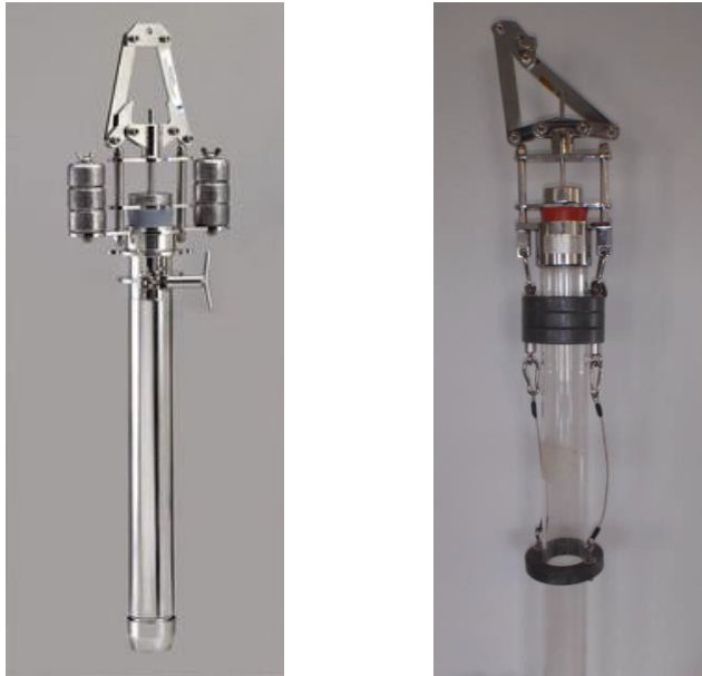
Figur 7.1a Eksempler på Kajak bundhentere med påmonteret rør. Foto KC Denmark A/S (venstre), Jens Christensen (højre).
