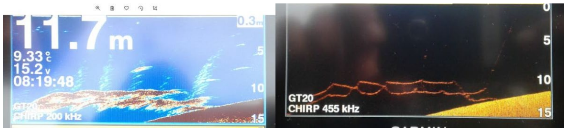
B. Garnet står horisontalt lige i 11-12 meters dybde, men over- og underline når hinanden flere steder. Dette kan skyldes, at garnet er snoet, eller at der er fanget i garnet. Foto: MST Midtjylland
