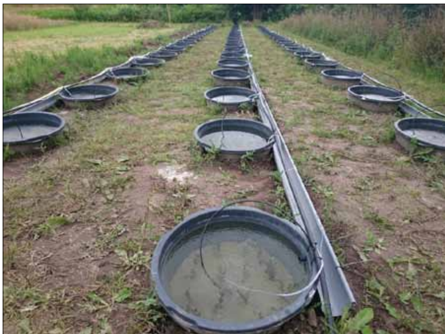
Fig. 1: Forsøgsopsætning bestående af 56 mesokosmos (ca. 5 cm sediment og 20-22 cm vandstand). Hver mesokosmos blev iltet og forsynet med 1,2 l vand i timen, hvor overskydende vand løb ud igennem et overløbsrør.
